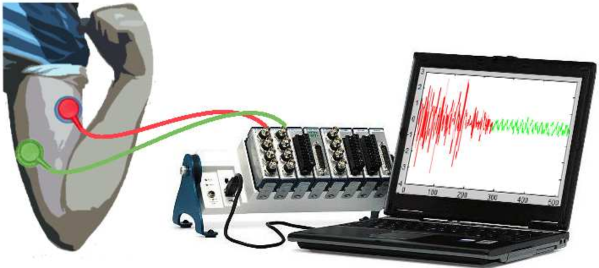
Şekil 2. Örnek EMG İşaretin Toplanması.
