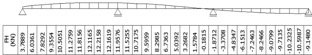
Şekil 25. \alpha=45^0 , t=6 s İçin Hidrodinamik Eksenel Kuvvet ( F_H ) Değerleri
