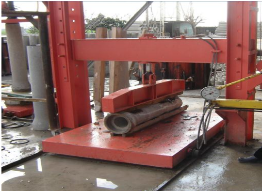
Şekil 4. Beton boruların tepe yükü dayanımlarının bulunması
