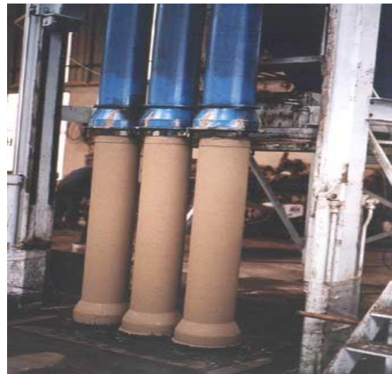
Şekil 2. Beton boru makinesinden çıkmış numuneler
