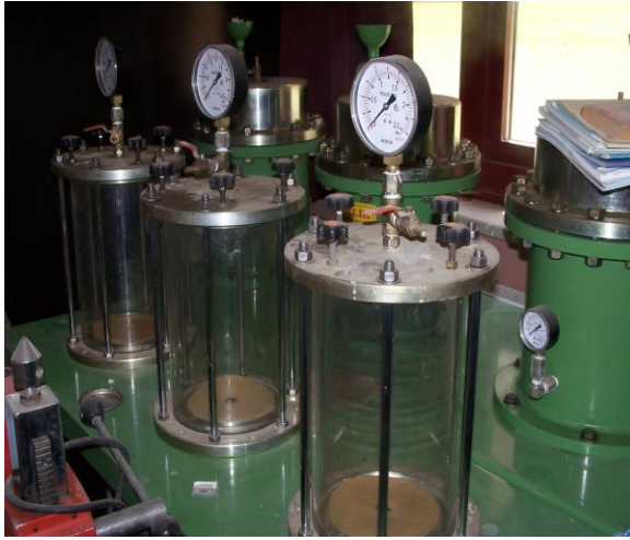
Şekil 5. Permeabilite cihazı ve örnekler
