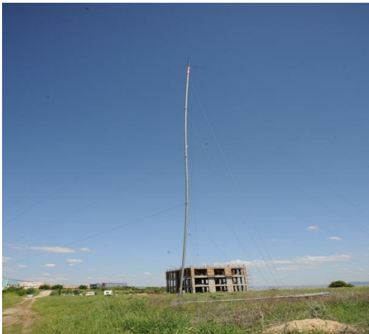
Şekil 3. Kampüste kurulan rüzgar ölçüm direği
