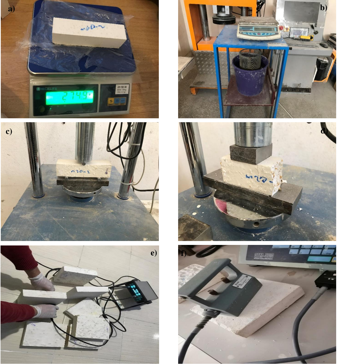
Şekil 3. Deneysel Çalışmalardan Görüntüler a) Birim Ağırlık Tayini b) Görünür Porozite Tayini c) Eğilme Dayanımı d) Basınç Dayanımı e) Ultrasonik Ses Geçiş Hızı f) Isıl İletkenlik Katsayısı Tayini
