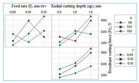
Figure 3. Variation of Fr versus cutting parameters (Kesme parametrelerine karşılık Fr'nin değişimi)
