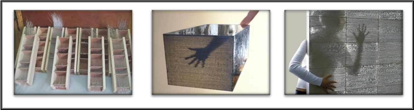
Şekil 1. (a) Ahşap Kalıba Yerleştirilen O.F. (Subathra ve Sangeetha, 2020), (b) Saydam Beton (Shen ve Zhou, 2021), (c) Litracon Classic (Litracon, 2022)
