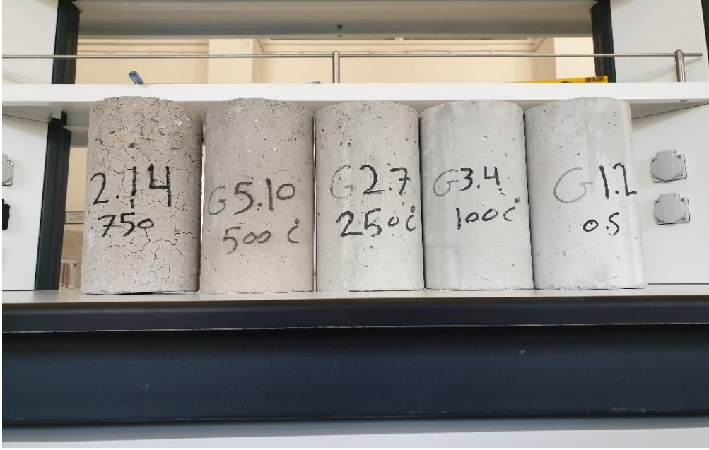
Şekil 10. Sıcaklık Değişimlerine Göre Numunelerde Meydana Gelen Görsel Değişim
