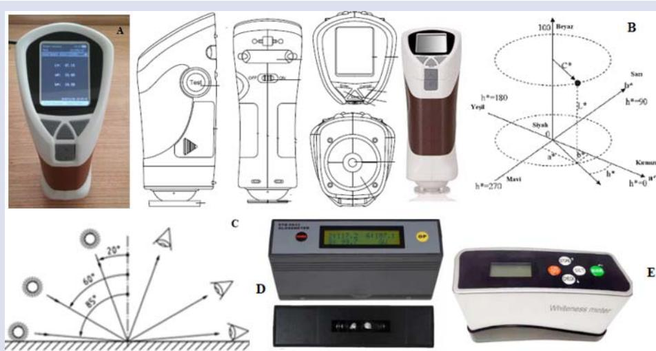
Şekil 1. Renk ölçüm cihazı (A), CIE  $L^*a^*b^*$ sistemi (Ruiz ve ark., 2012) (B), ölçüm açıları (ISO 2813, 2014) (C), parlaklık ölçüm cihazı (D) ve beyazlık indeksi ölçüm cihazı (E)
