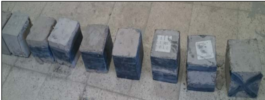
Şekil 12. Basınç Deneyi Sonrası Numune Durumları
