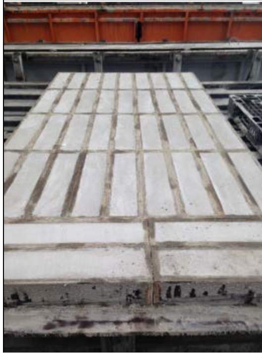
Şekil 5. Kiriş Numunelerinin Hazırlanması
