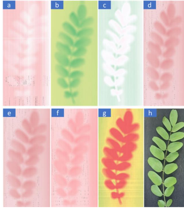
Şekil 4. Yeşil Bir Bitkinin Mavi (a), Yeşil (b) Kırmızı (c) Görünür Bantlarda, Kızılötesi Bantlarda (d-f), Tam Spektrum Reflektansı (g) ve Asıl Görüntüsü (h)
