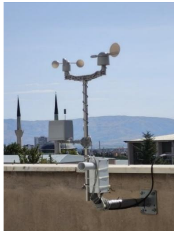
Şekil 6. Hava İstasyon Modülü
