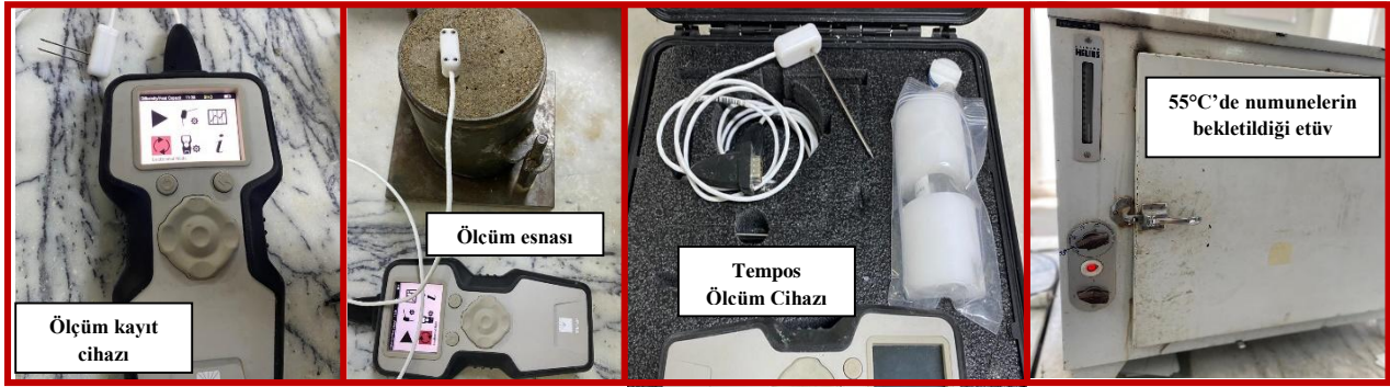
Şekil 4. Termal İletkenlik Ölçüm Ekipmanları
