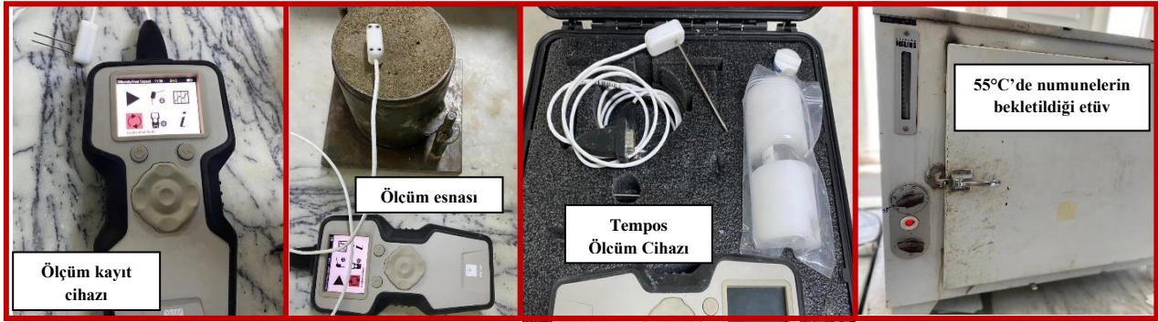
Şekil 4. Termal İletkenlik Ölçüm Ekipmanları
