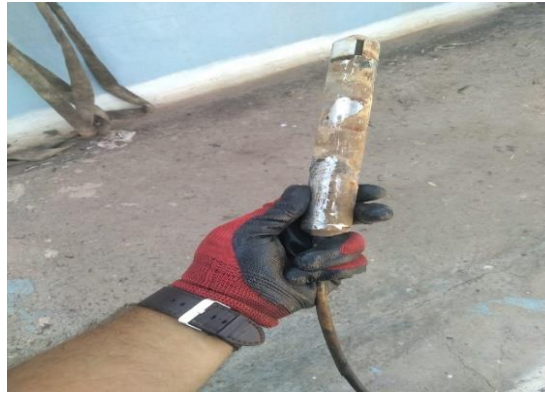
Şekil 9. Arızalı seviye ölçüm sensörü
