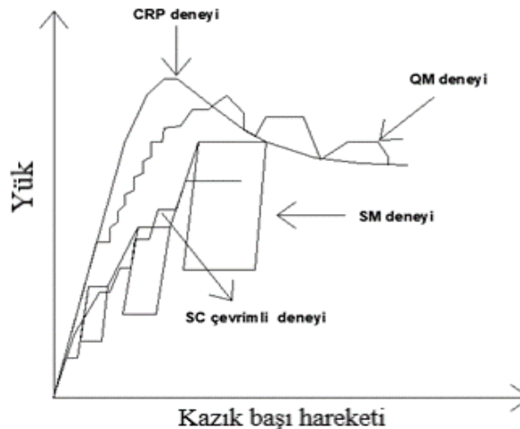
Şekil 1. Farklı Deney Yöntemleri İçin Yük-Oturma İlişkisinin Karşılaştırılması [Toğrol (1970)]
