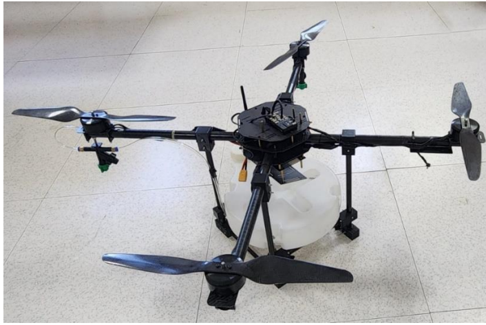
Şekil 1. Çalışmada Kullanılan Özel Tasarlanmış 4 Rotorlu Drone
