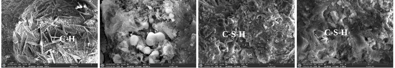
Şekil 11. 10NS-0PL Serisine Ait SEM Analizi Sonuçları
