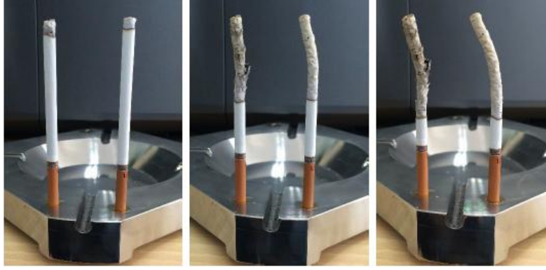
Şekil 24. Geleneksel (sol) ve kenevir (sağ) sigara kağıdının farklı yanma derecelerindeki kül görünümü (Yao vd., 2017).
