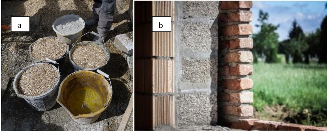
Şekil 13. a. Kenevir Beton (Hempcrete) b. Kenevir Beton Bloklar (Muhit vd., 2024).
