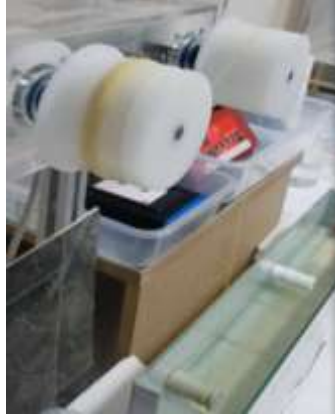
Şekil 2. (a) Yaş Lif Çekim Düzenegi, (b) Düzedeki Deliklerden Viskoz Lif Çekim Çözeltilisinin Koagülasyon Banyosu İçerisine Sevki (Düze Delik Çapı: 0.1mm*91 Adet), (c) Pamuk Teleflerinden Üretilen Viskoz Rayon Liflerinin Godetlere Sarımı
