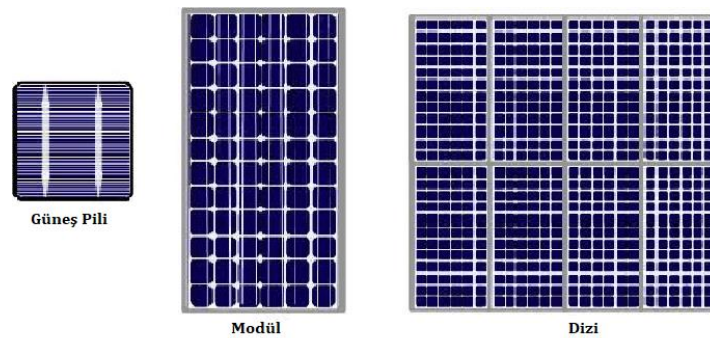
Şekil 1. Güneş Pili, Modül ve Dizi
