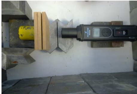
Şekil 2 Radyasyon iletkenliği ölçüm cihazı ve deney düzeneği
