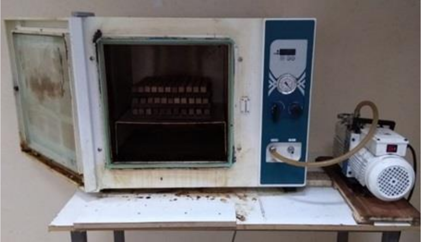
Şekil 2. Test Örneklerine Vakumlu Etüvde Isıl İşlem Uygulaması
