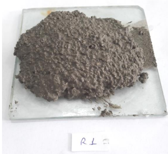
Şekil 4. R1 Karışımı Taze Yaş Harç Formu
