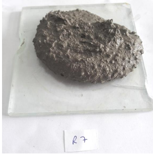
Şekil 6. R7 Karışımı Taze Yaş Harç Formu
