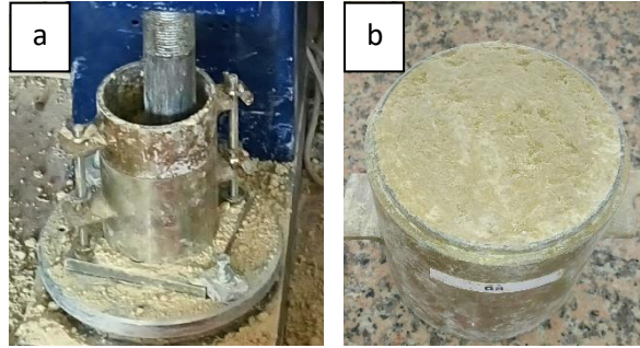
Şekil 4. a. Standard Proktor Deneyinin Yapılışı b. Proktor Kalıbında Sıkıştırılmış Örnek
