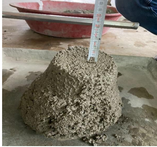
Şekil 4. Slump (çökme) deneyi
