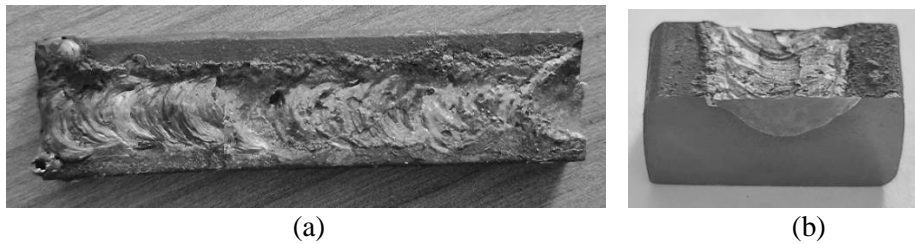
Şekil 4. a) Yüzey Alaşımlama Sonrası Numunenin, b) Mikroyapı İncelemesi İçin Kesit Numunenin Makro Resimleri
