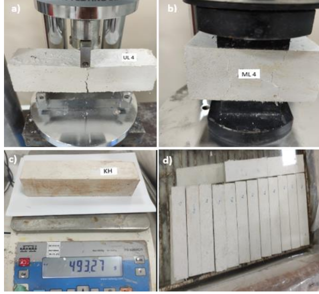
a). Eğilme Dayanımı Analizi, b). Tek Eksenli Basınç Dayanımı Analizi, c). Birim Hacim Ağırlık Tayini, d). Kütlece Su Emme Analizi
