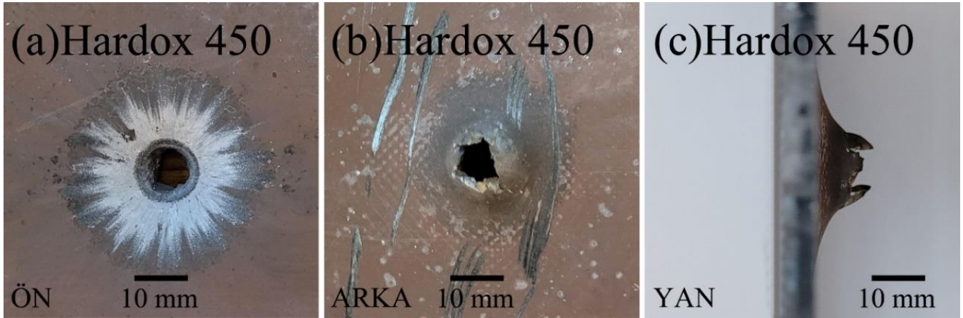
Şekil 4. 4H Monolitik Zırh Yapısının Balistik Test Sonucu a. 4 mm Hardox 450 Zırh Plakasının Ön Yüzü b. 4 mm Hardox 450 Zırh Plakasının Arka Yüzü c. 4 mm Hardox 450 Zırh Plakasının Yan Yüzü Görselleri
