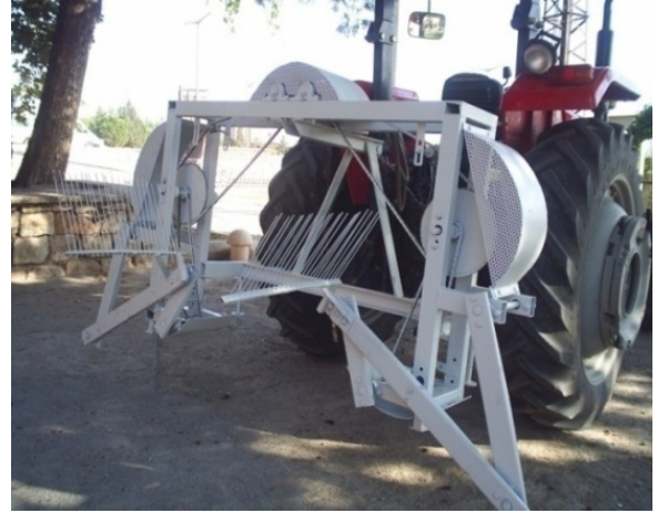
Şekil 6. Simülasyon yazılımı kullanılarak geliştirilmiş biber hasat makinesi prototipi
