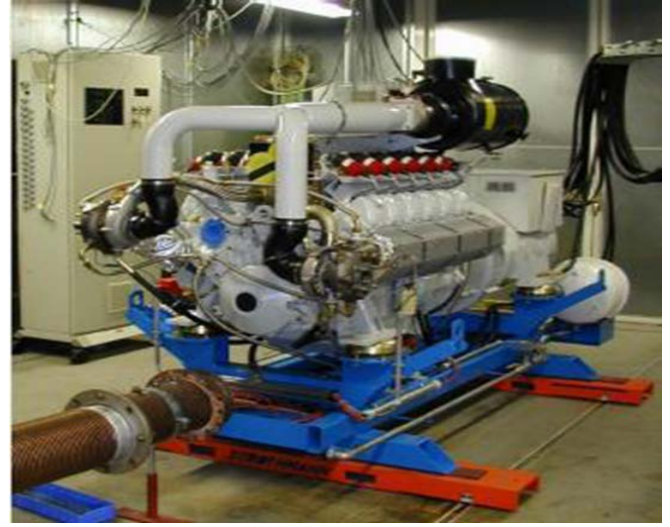
Şekil 3. Gaz Motorlu Kojenerasyon Sisteminde Kullanılan Motor Tipi (2330 kW)
