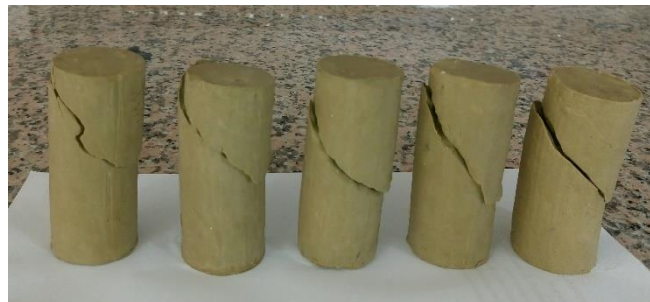
Şekil 6. Üç Eksenli Sıkışma Dayanımı Deney Sonrası Örneklerdeki Yenilmeler
