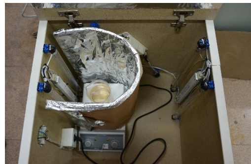
Şekil1: Deneylerde kullanılan UV-Fotooksidasyon deney düzeneği
