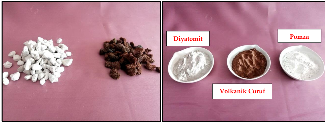
Şekil 1. Kompozit Harç Tasarımlarında Kullanılan Malzemelerin Görünümü
