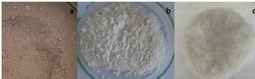
Şekil 1. a) Kil Numunesi b) Keçiyoynuzu Gam c) Polyester İplik
