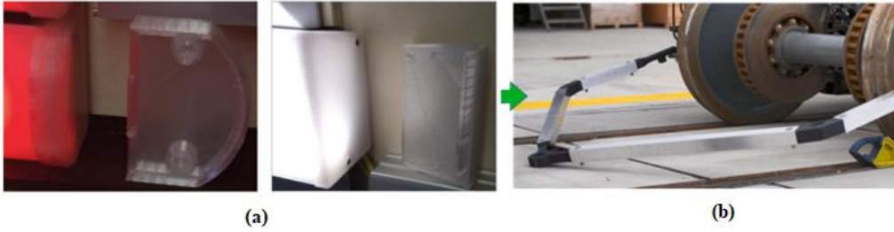
Şekil 21. a. Demiryolu Araçlarında LED Armatürlerin 3B Basılmış Plastik Uç Kapakları (Hohenwarter vd., 2020) b. Bir Trende Eklemeli İmalatlı Boji Konnektörü (Wu vd., 2023).
