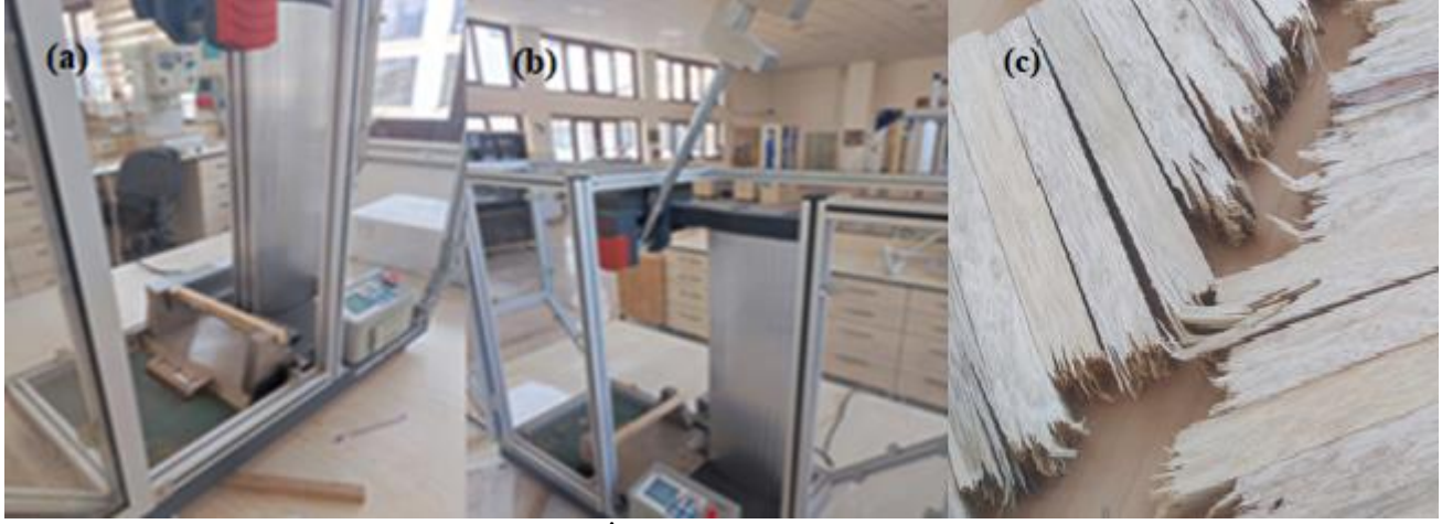
Şekil 2. Dinamik Eğilme Direncinin Tespitine İlişkin Görüntüler; (a), (b) Deneş Düzeneęi, (c) Dinamik Eğilme Sonrası Meydana Gelen Kırılmalar
