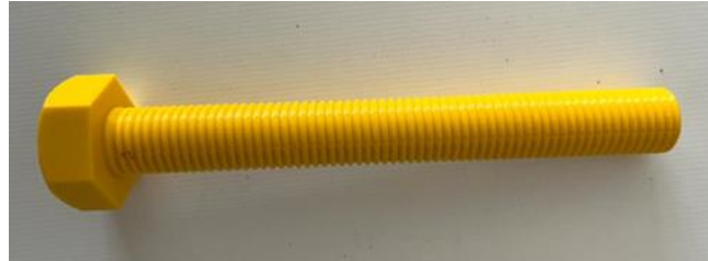
Şekil 3. 3D Yazıcıyla Üretilen M20 Cıvata
