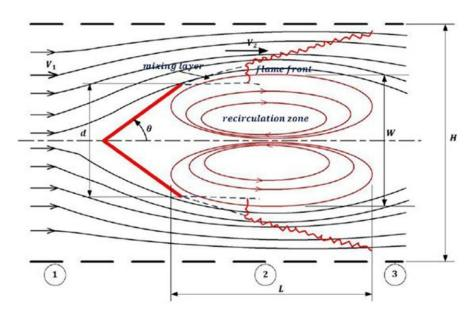
Fig. 1. Afterburner design parameters [25].
