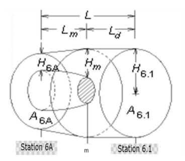
**Fig. 6.** Geometric parameters of diffuser.
