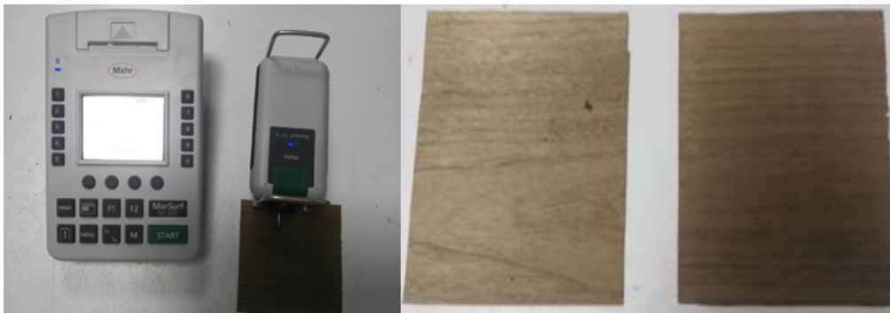
Şekil 1. Marsurf M300 yüzey pürüzlülük cihazı ve MDF test örnekleri
