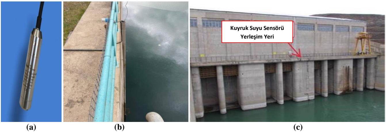
Şekil 8. a. Dalgıç Tipi Sensör b. Sensörün Daldırılma Şekli c. Sensörün Daldırıldığı Yer
