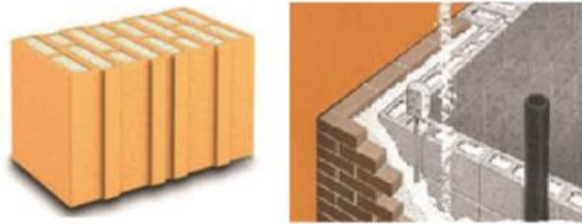
Şekil 5. Perlitin Dolgu Malzemesi Olarak Kullanımı (Yıldız, 2014)
