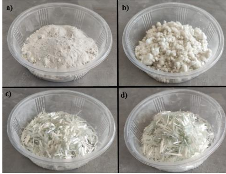
Şekil 1. Lif Görselleri a. Mikronize Cam Lifi b. Taraklanmış Cam Lifi c. 6mm Cam Lifi d. 12mm Cam Lifi
