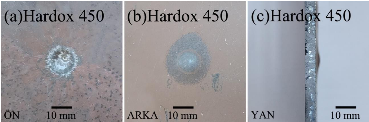
Şekil 5. 6H Monolitik Zırh Yapısının Balistik Test Sonucu a. 6 mm Hardox 450 Zırh Plakasının Ön Yüzü b. 6 mm Hardox 450 Zırh Plakasının Arka Yüzü c. 6 mm Hardox 450 Zırh Plakasının Yan Yüzü Görselleri
