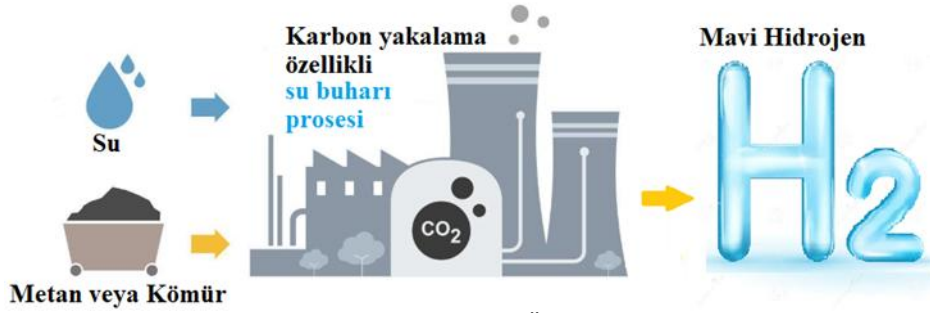
Şekil 3. Mavi Hidrojen Üretim Prosesi
