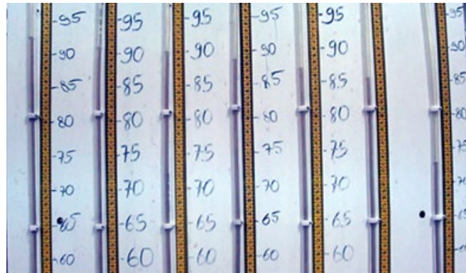
Şekil 3. Alüminyum boru 1. deney 05. saniyede çekilen görüntü ( Re = 50067 )
