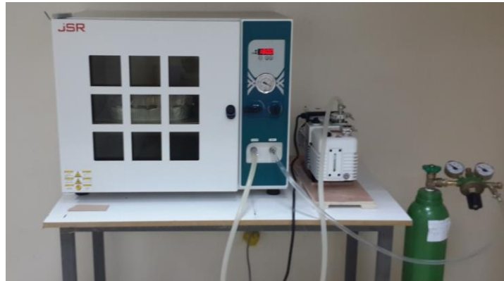
Şekil 2. Isıl işlem uygulamasında kullanılan vakumlu etüv, vakum pompası ve azot gazı tüpü
