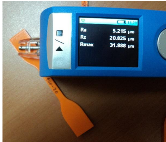
Şekil 3. Yığıma Yönüne 90° Açılı Pürüzlülük Ölçüm Görüntüsü
