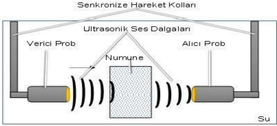
Şekil 3. TTU Çalışma Prensibi
