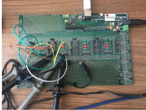
Şekil 5. AN231K04-QUAD4 Tipi FPAA Geliştirme Kartı ve Picoscope Osiloskop Deneysel Kurulum
