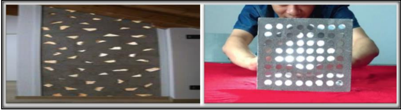
Şekil 3. (a) Atık Cam İçeren Saydam Beton Panel (Pilipenko vd., 2018). (b) Polimer Reçine İçeren Saydam Beton Panel (Emanet, 2022).
