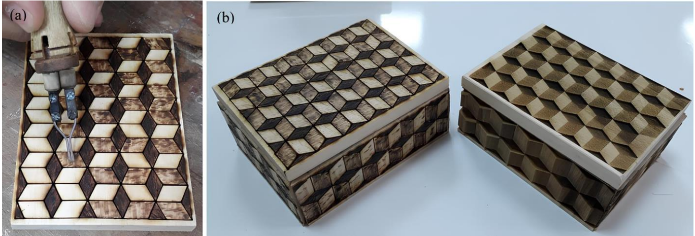
Şekil 4. (a) Geleneksel Pirografi İşleme Aşaması, (b) Mamül Geleneksel ve Lazer Pirografi Ahşap Kutular
