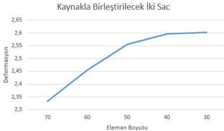
Şekil 13. Kaynakla Birleştirilecek İki Sac Problemi Mesh Yakınsama Uygulaması
