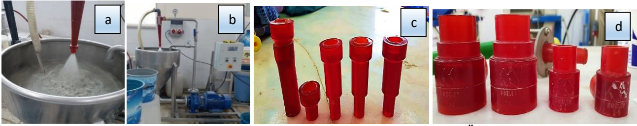
Şekil 1. a. Hidrosiklon Düzeneği, b. Genel Görüntüsü, c. Alt Çıkış (Apex) d. Üst Çıkış (Vortex) Parçaları
