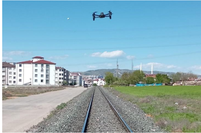
Şekil 8. İHA ile Elazığ Demiryolundan Görüntü Toplama
