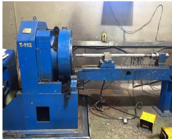
Şekil 5. Büzme İşleminde Kullanılan Büzme Makinesi
