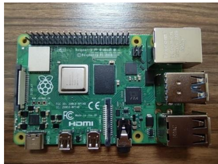
Şekil 1. Projede Kullanılan Raspberry Pi 4 Kontrolcü Kartı
