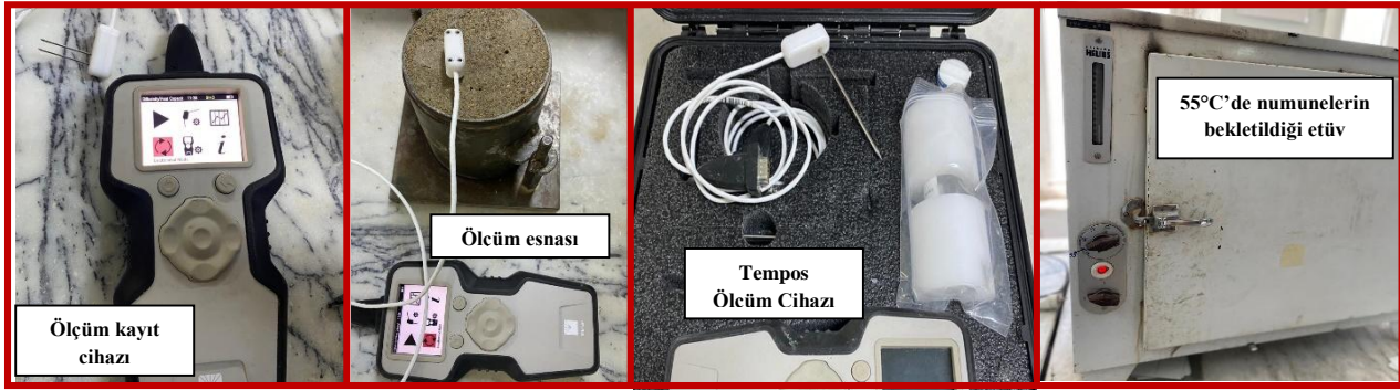
Şekil 4. Termal İletkenlik Ölçüm Ekipmanları
