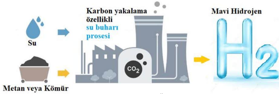
Şekil 3. Mavi Hidrojen Üretim Prosesi
