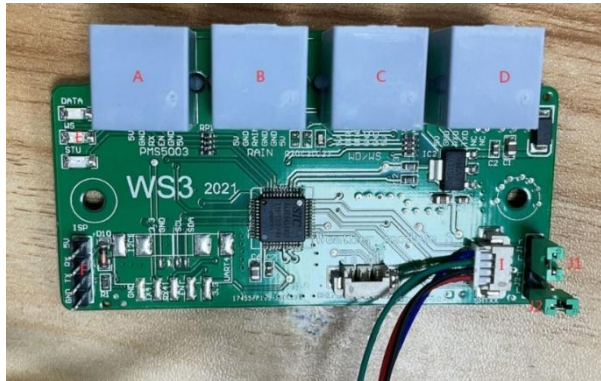
Şekil 3. SEN0186 Hava İstasyon Modülü Sensör Kartı
