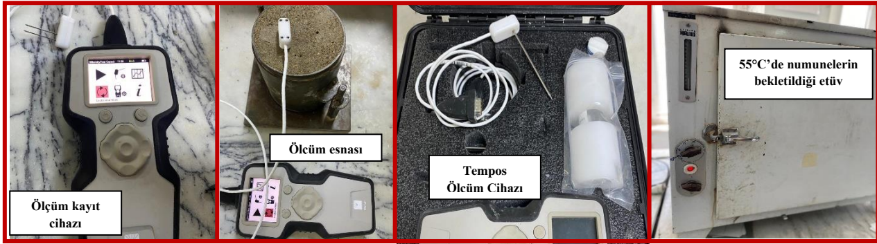
Şekil 4. Termal İletkenlik Ölçüm Ekipmanları
