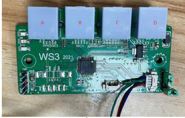
Şekil 3. SEN0186 Hava İstasyon Modülü Sensör Kartı
